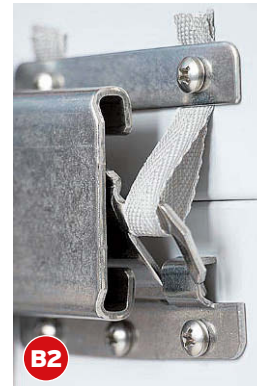
B2 Wird versucht, den Rollladen anzuheben, hakt die Platte ein
